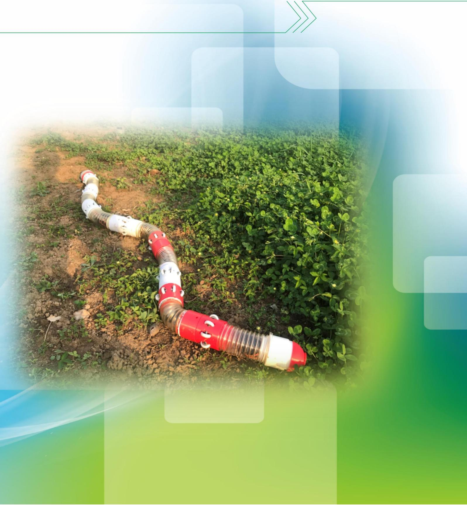
本项目设计的水陆两栖勘测云机器蛇——被誉为“最具动感的机器人”，其仿生的身体结构、独特的运动方式和功能的高集成度，使其可执行水陆环境中人工难以完成或无法完成的勘测任务。此外，其克服了传统机器人体积大、行动不灵敏等缺点，能够适应各种复杂、狭窄的水陆环境，从而可应用于灾后救援路径的规划、管道的检修和疏通、水产养殖的巡视作业、军事侦察等领域。
